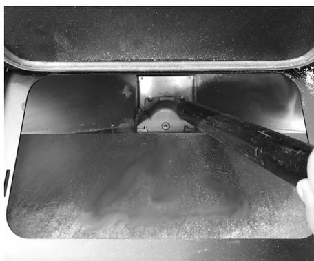
**Fig. 35 - Pulizia serbatoio e coclea**
