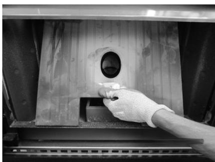
*Fig. 39 - Rimozione ghisa centrale*
