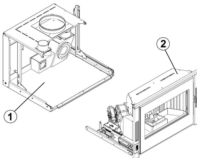
Fig. 16 - Struttura + corpo macchina
