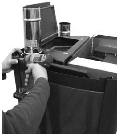
Fig. 91 - Rimozione profili curvi superiori
