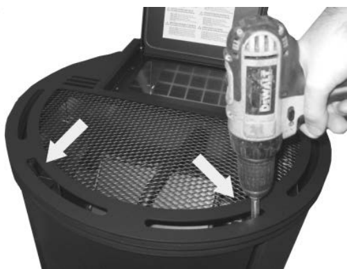
Fig. 81 - Rimozione viti coperchio 1
