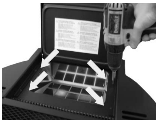
Fig. 82 - Rimozione viti coperchio 2
